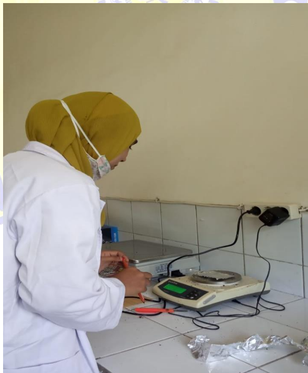
2) Uji Laboratorium Kadar lengas tanah ditimbang
