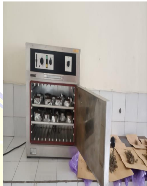
1) Uji Laboratorium berat volume (BV) tanah di oven
