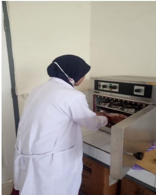
1) Uji Laboratorium berat volume (BV) tanah di oven
