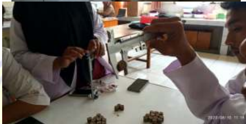
Pengukuran Dimensi Kompos Tablet
