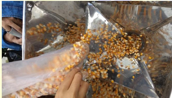
Gambar 2. Proses memasukan benih jagung kedalam wadah alat penanam jagung
