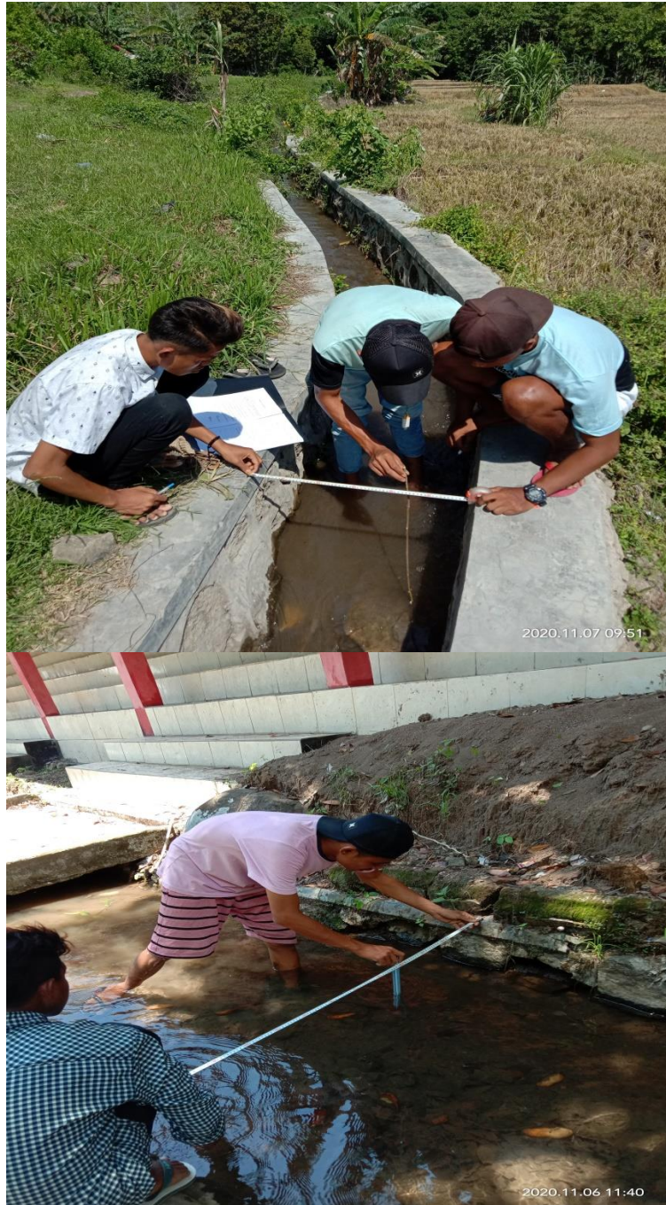
Keterangan: mengukur lebar atas bawah saluran
