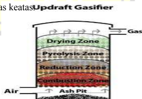
Gambar 4. Gasifikasi Tipe Updraft
