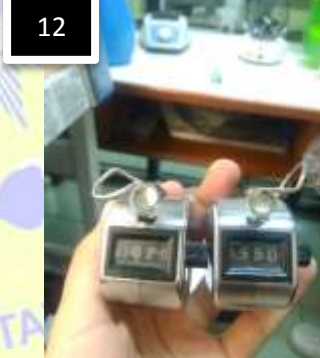
Counter = alat untuk menghitung parasit, kanan untuk menghitung eritrosit yang kiri untuk parasit
