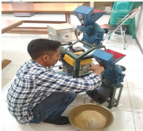
Proses Penggilingan Rumput laut ( Eucheuma cottonii ) dengan mesin heller
