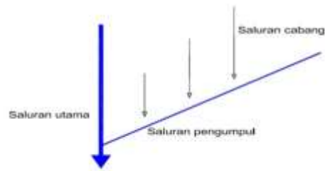
Gambar 2.4 jaringan drainase pola grid iron (Sumber :Tamimi, 2015)
