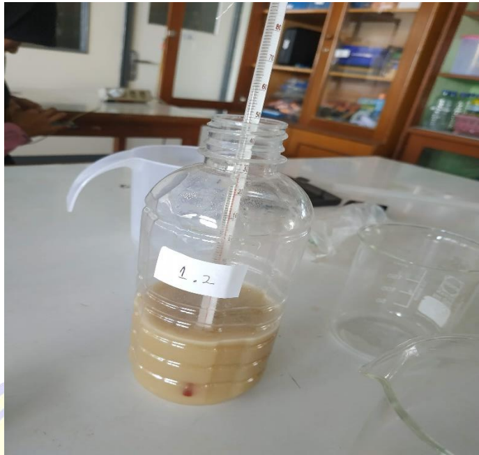
Gambar 37. Pengukuran suhu larutan PGPR
