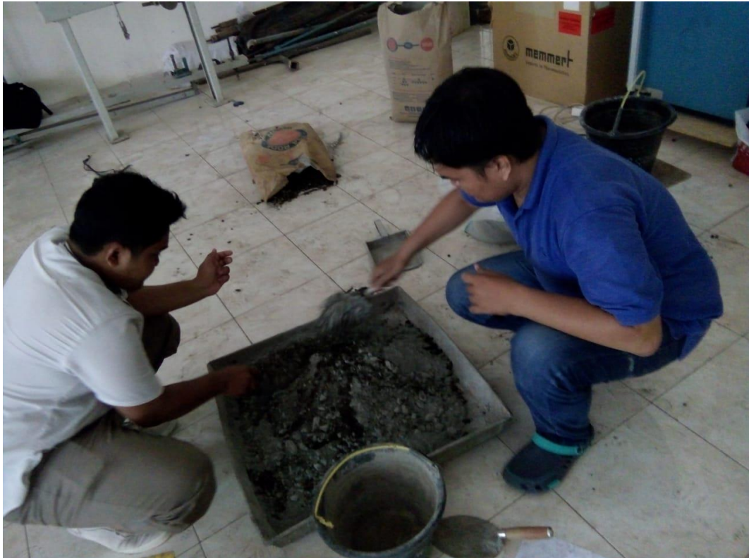
Pencampuran Material Dan Serat Untuk Benda Uji
