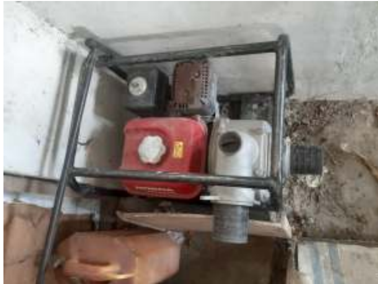
Pompa air untung mengalir air dari sungai hingga flume untuk eksperimen
