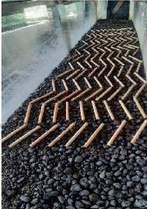
Formasi debris kayu ( dihanyutkan 125 batang)
