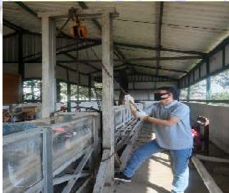
Menaikan flume hingga mencapai kemiringan 0.06 m
