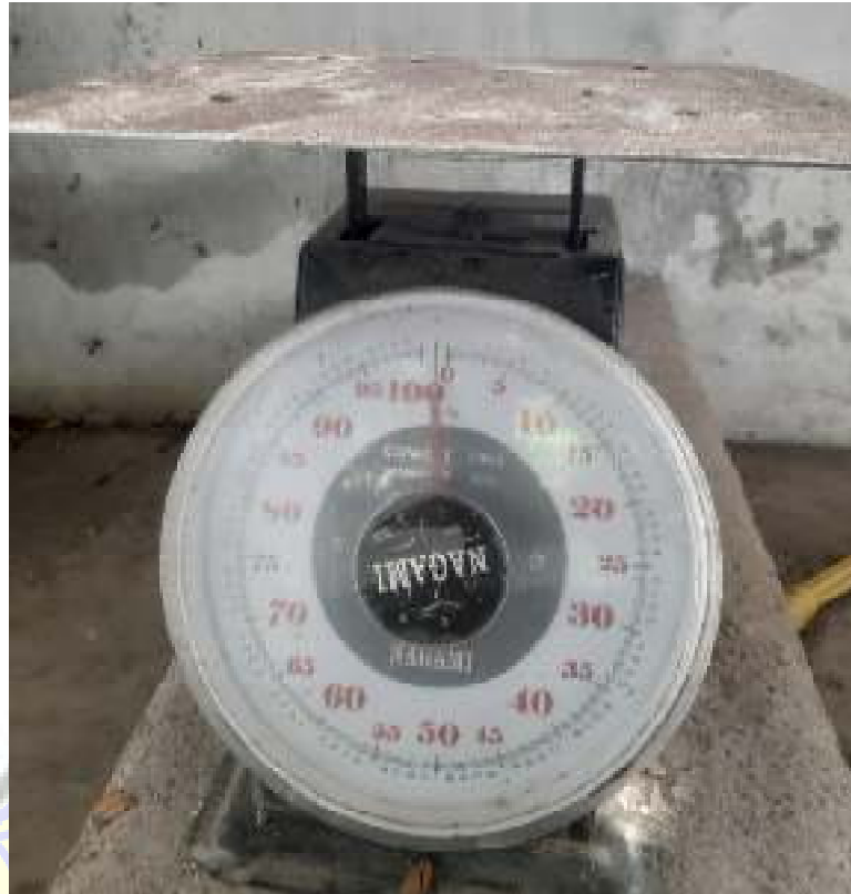
Timbangan untuk menimbang berat air dalam ember (alat bantu untuk menghitung debit aliran)
