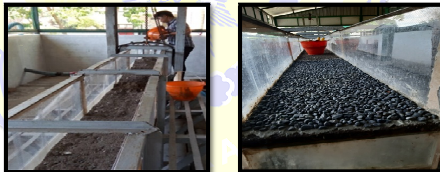
Gambar 3.5 Dasar Tidak tetap, (a) Proses Penumpahan dan (b) Proses perataan permukaan.
