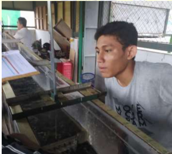
Mengukur elevasi muka air di hulu dan di hilir sabodam
