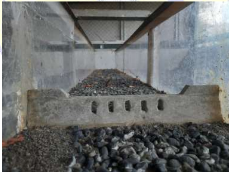
Memasang sabo dam pada flume
