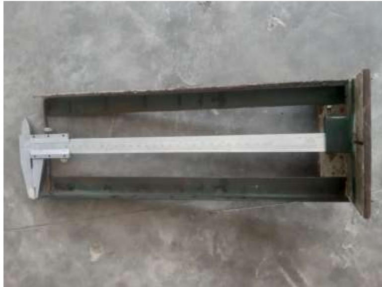
Jangka sorong alat untuk mengukur kedalaman dasar dan elevasi muka air
