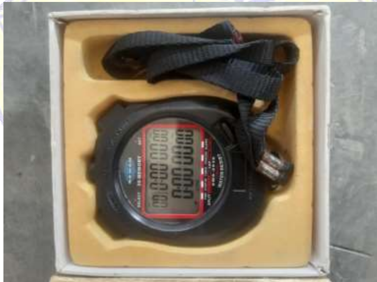
Stopwat alat bantu untuk menghitung debit aliran
