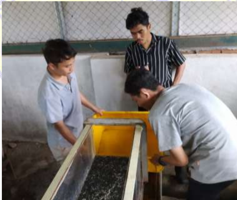
Mengukur kembali besar kecilnya debit untuk memastikan debit yang ada telah stabil
