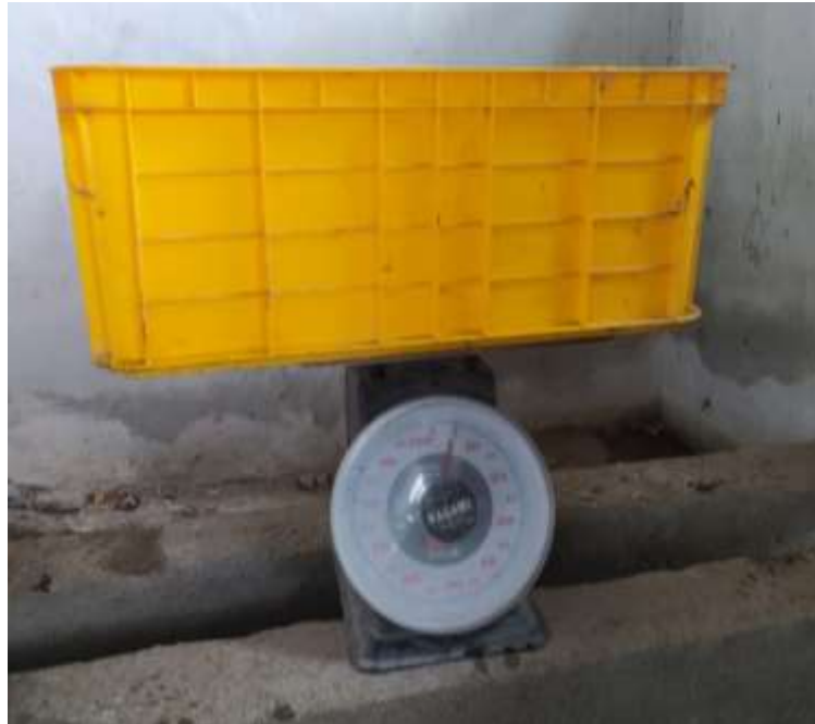
Menimbang berat air untuk menghitung debit yang di rencanakan
