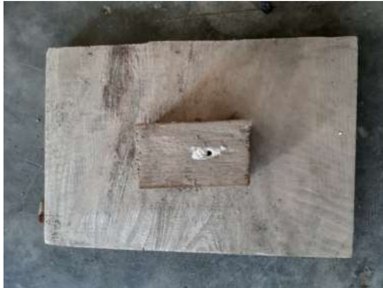
Papan kayu untuk memadatkan dasar tidak tetap setiap ingin memulai kembali eksperimen baru
