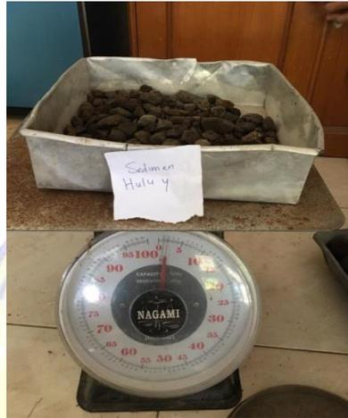
Gambar 3.6 Benda Uji Setelah Dioven
