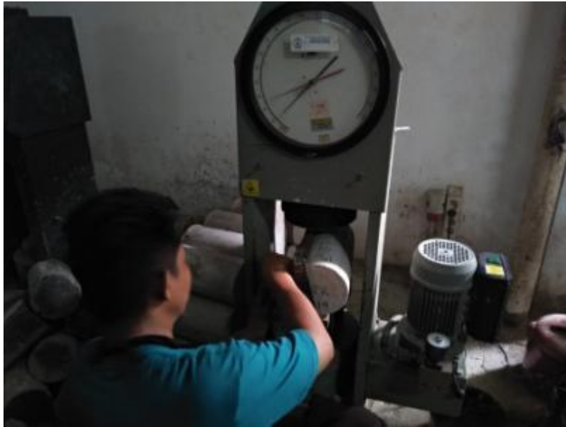
PENGUJIAN KUAT TARIK BELAH BETON
