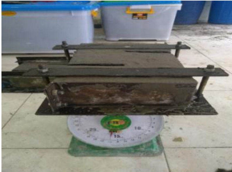
PENIMBANGAN CETAKAN + BETON SEGAR
