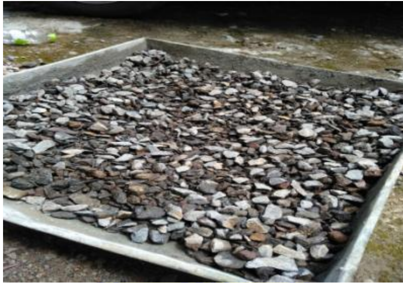
PENGERINGAN AGREGAT KASAR
