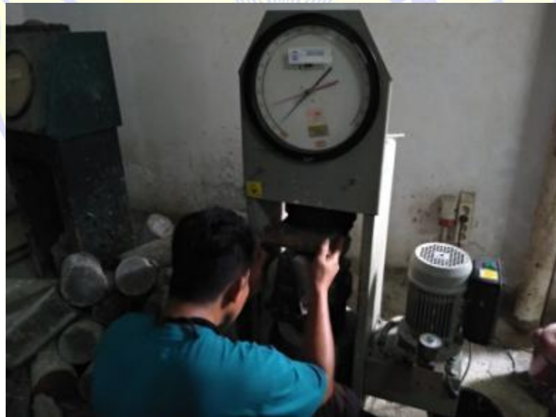
PENGUJIAN KUAT TARIK BELAH BETON
