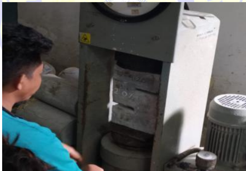
PENGUJIAN KUAT GESER BETON
