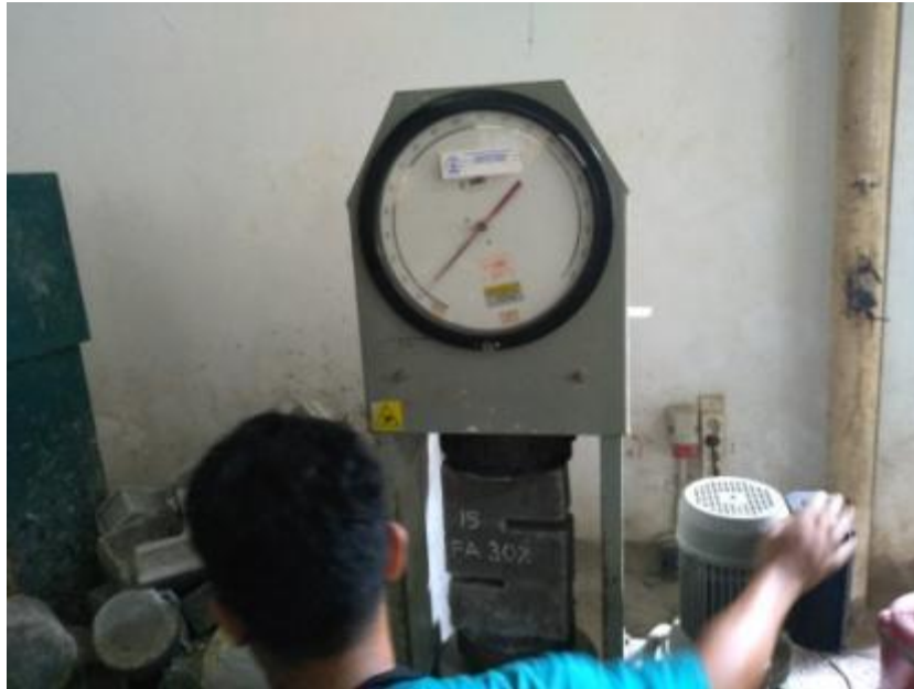
PENGUJIAN KUAT GESER BETON
