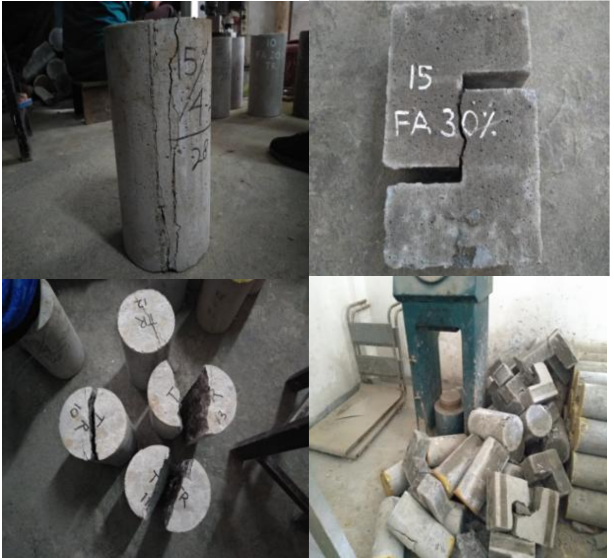
KERUNTUHAN BENDA UJI SILINDER DAN DOUBLE-L SETELAH PEMBERIAN BEBAN MAKSIMUM
