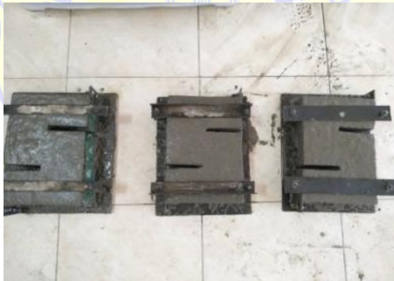
BETON SEGAR SESUDAH DI TIMBANG
