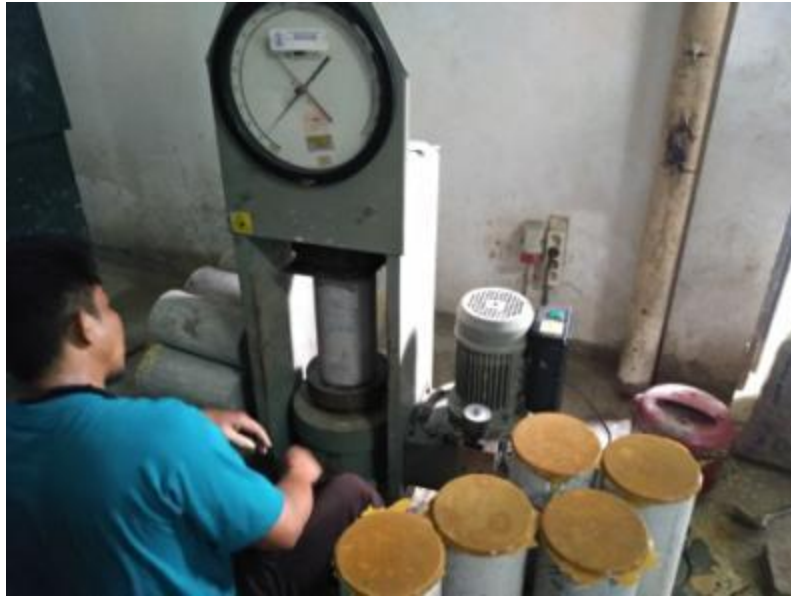
PENGUJIAN KUAT TEKAN BETON
