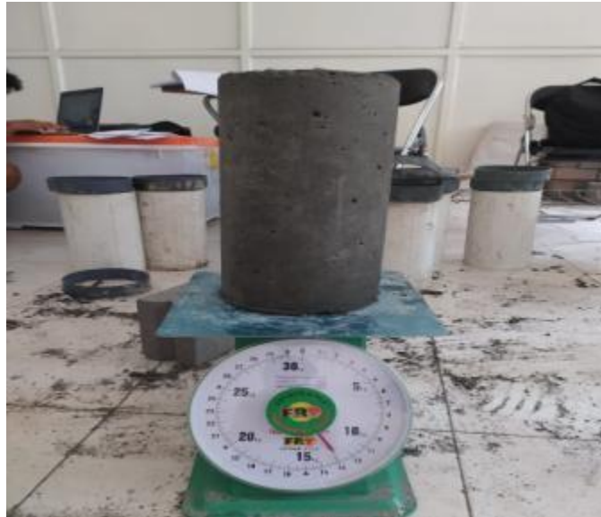
PENIMBANGAN BENDA UJI SILINDER BETON KERING
