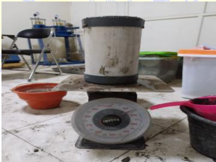
PENIMBANGAN CETAKAN + BETON SEGAR
