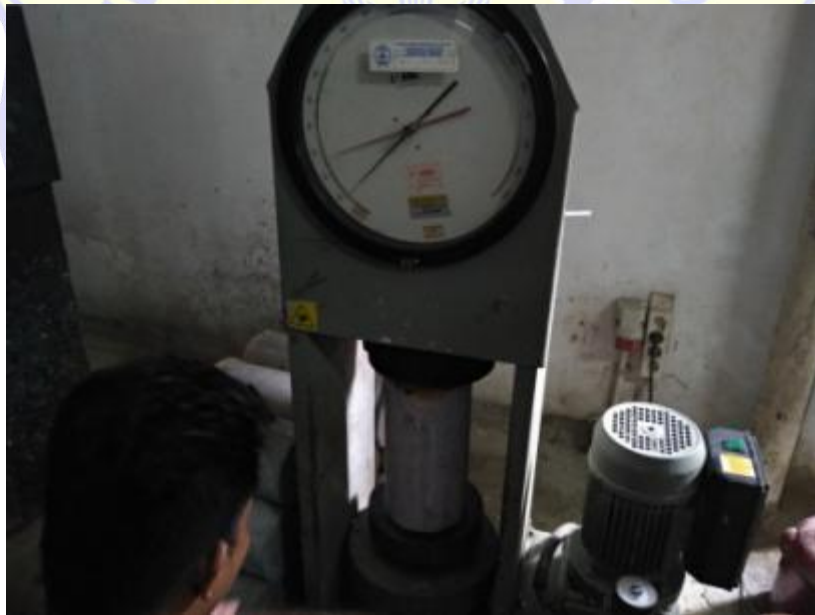
PENGUJIAN KUAT TEKAN BETON
