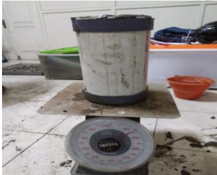
PENIMBANGAN CETAKAN + BETON KERING
