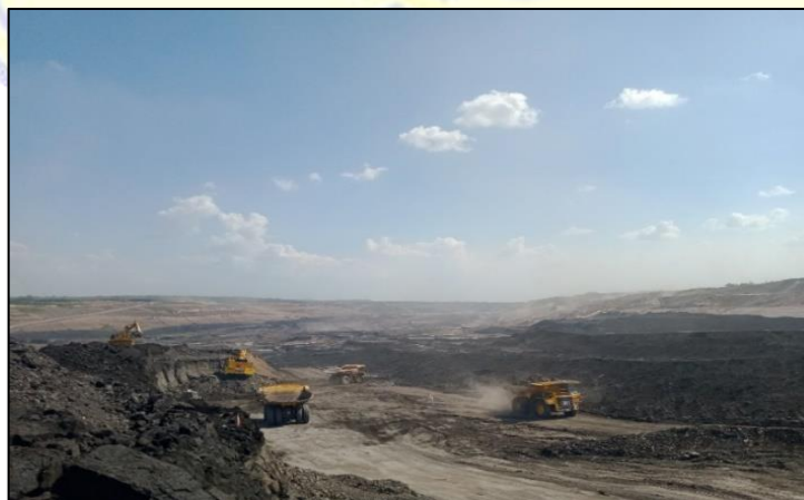
Gambar 2.10 Pemuatan dan Pengangkutan Overburden (Sumber : Dokumentasi Penulis, 2023)
