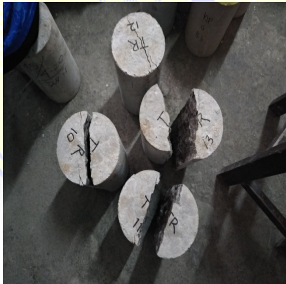
KERUNTUHAN BENDA UJI SILINDER SETELAH PEMBERIAN BEBAN MAKSIMUM
