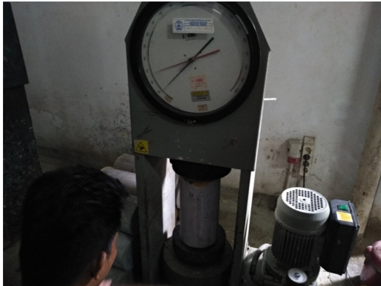
PENGUJIAN KUAT TEKAN BETON
