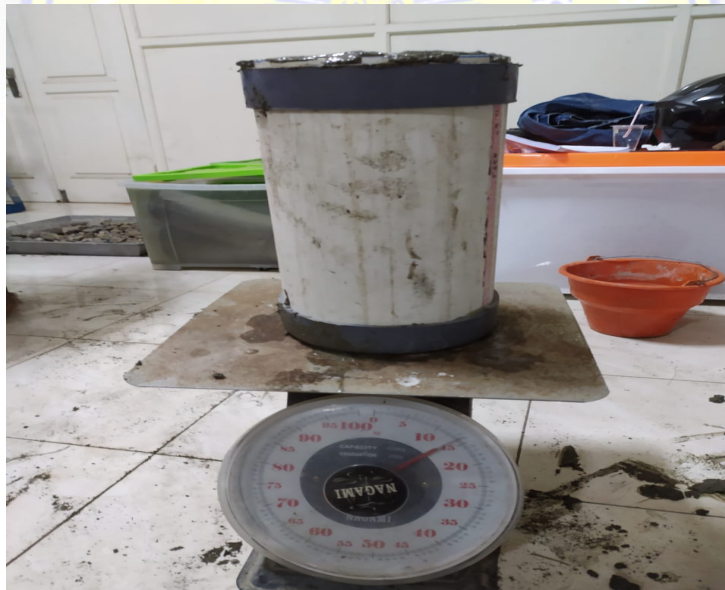
PENIMBANGAN CETAKAN + BETON KERING
