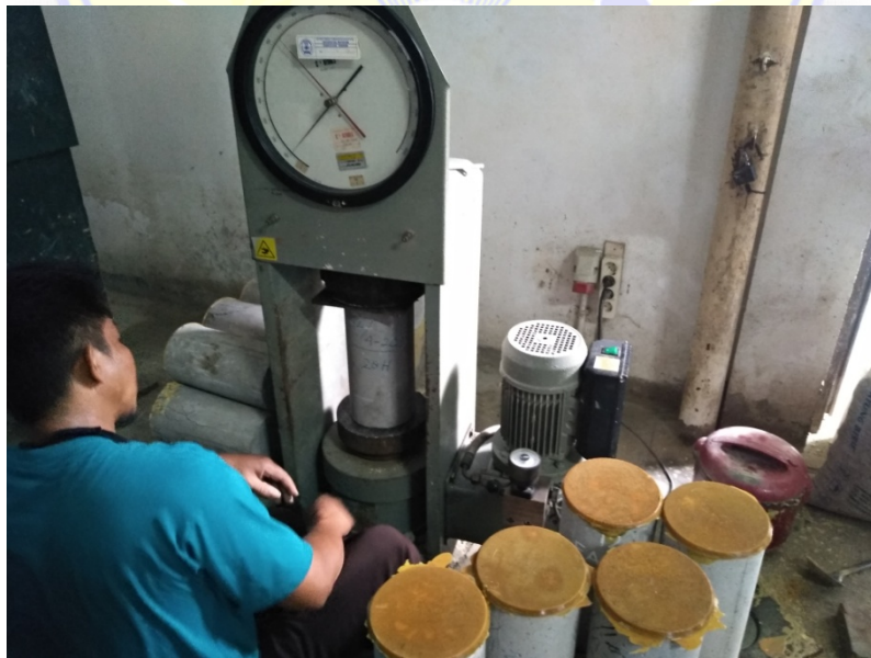
PENGUJIAN KUAT TEKAN BETON
