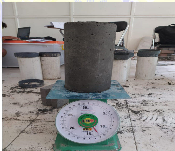
PENIMBANGAN BENDA UJI SILINDER BETON KERING
