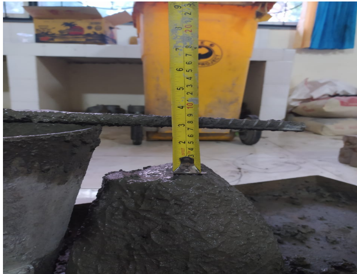
PEMERIKSAAN NILAI SLUMP BETON SEGAR
