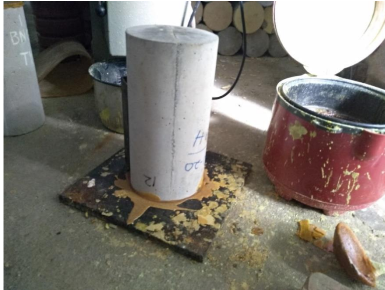
CAPPING BENDA UJI SILINDER UNTUK PENGUJIAN KUAT TEKAN
