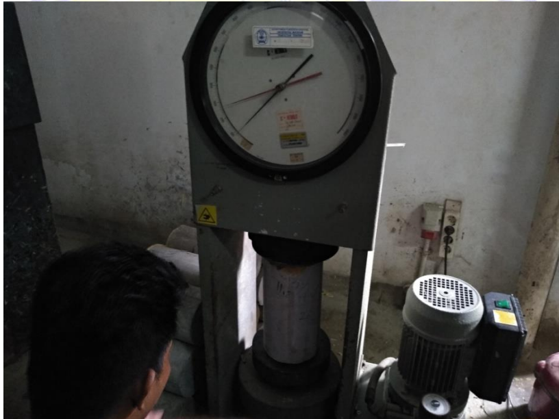
PENGUJIAN KUAT TEKAN BETON
