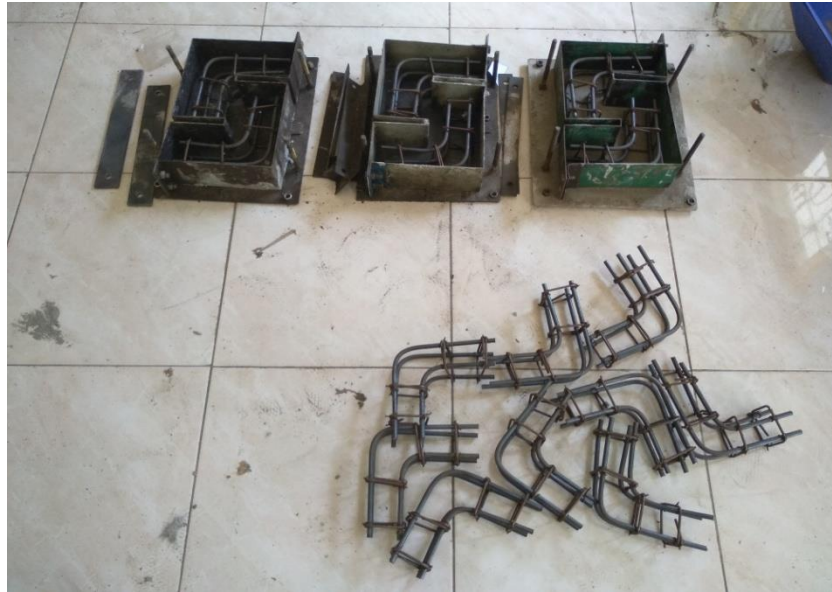
PERSIAPAN CETAKAN DAN TULANGAN DOUBLE-L
