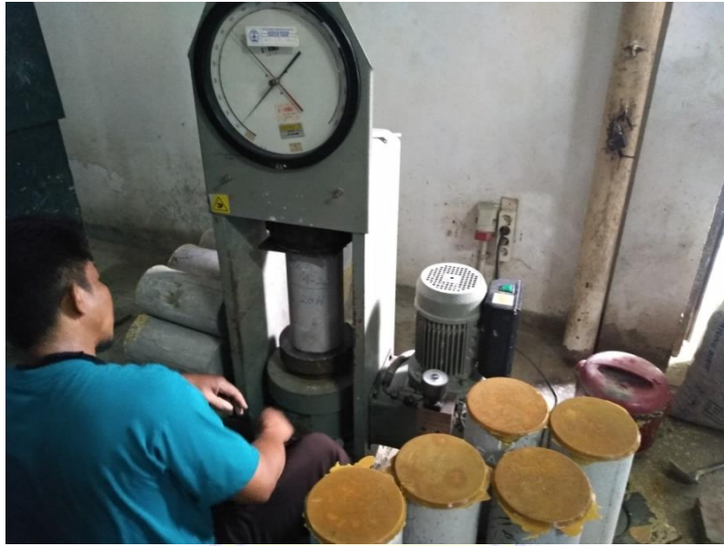
PENGUJIAN KUAT TEKAN BETON
