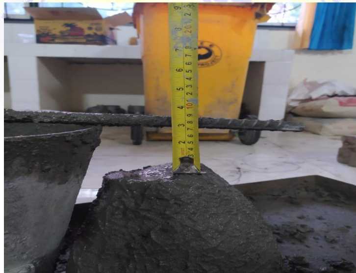
PEMERIKSAAN NILAI SLUMP BETON SEGAR
