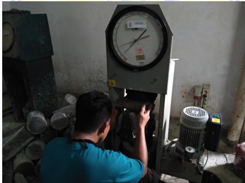
PENGUJIAN KUAT TARIK BELAH BETON
