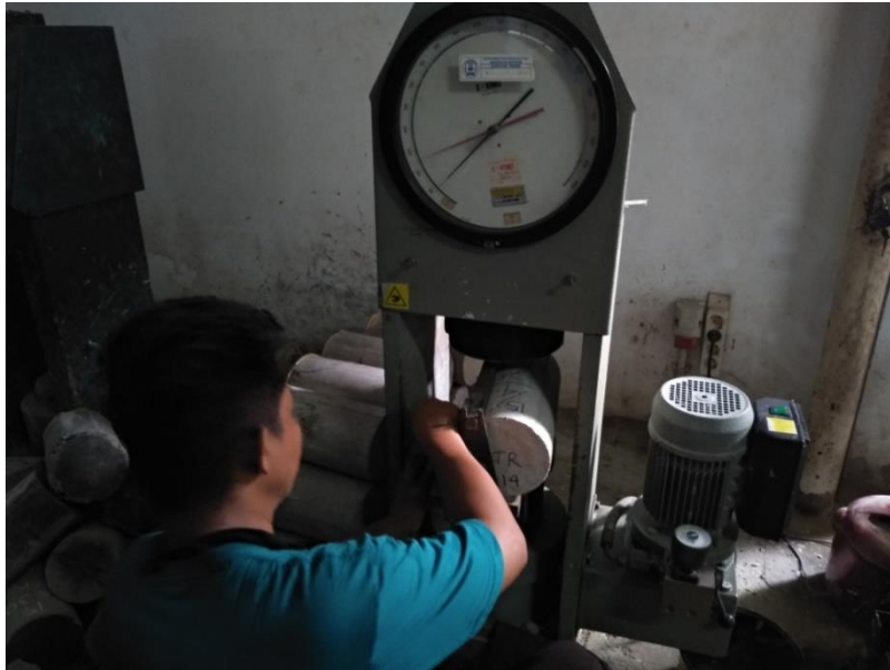
PENGUJIAN KUAT TARIK BELAH BETON
