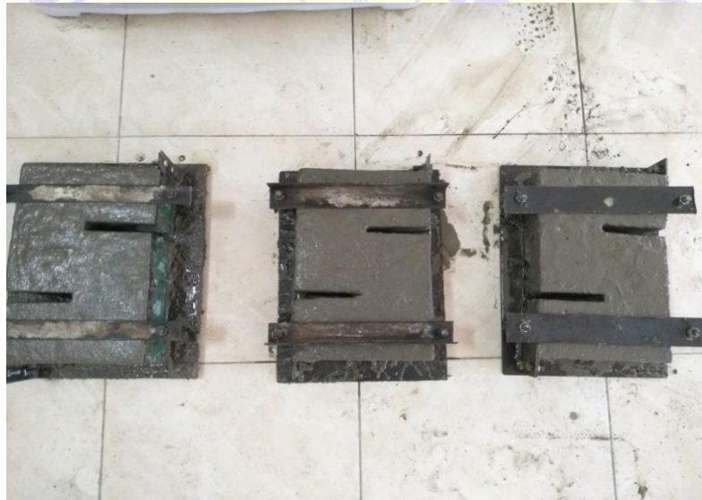
BETON SEGAR SESUDAH DI TIMBANG
