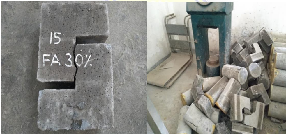
KERUNTUHAN BENDA UJI SILINDER DAN DOUBLE-L SETELAH PEMBERIAN BEBAN MAKSIMUM
