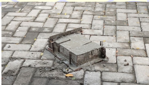
Gambar 3.19 Cetakan Beton Double L (sumber: dokumentasi pribadi, 2024)
