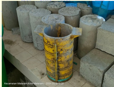
Gambar 3.11 Cetakan beton (sumber: dokumentasi pribadi, 2024)
