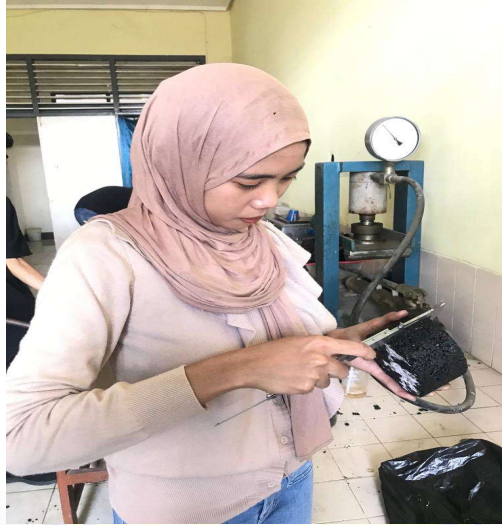
Proses pengukuran tebal benda uji
