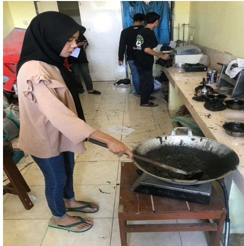
Proses menggoreng agregat dicampur aspal
