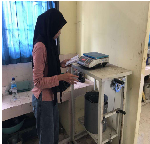
Proses penimbangan benda uji dalam air
