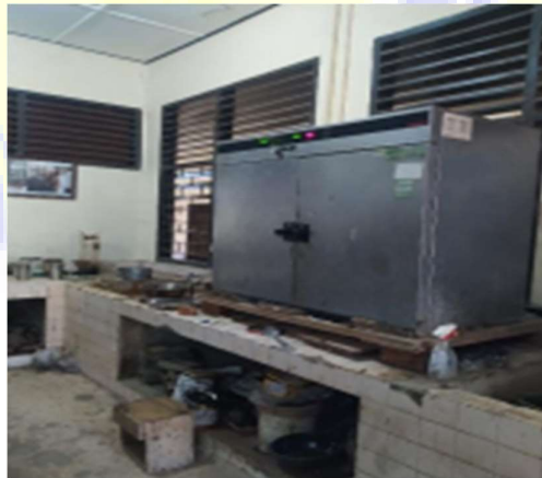
Gambar 3. 3 Oven Atau Pemanas Agregat
