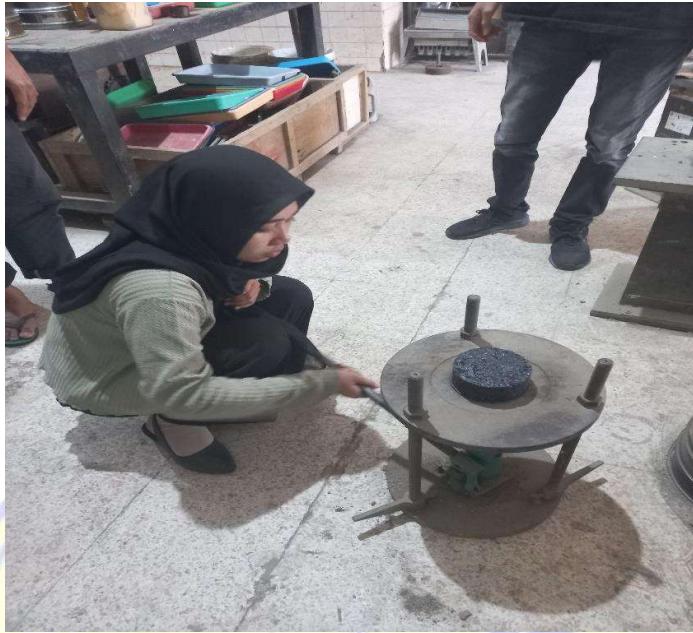
Proses mengeluarkan benda uji menggunakan dongkrak hidrolik
