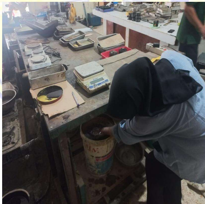
Penimbangan berat benda uji di dalam air
