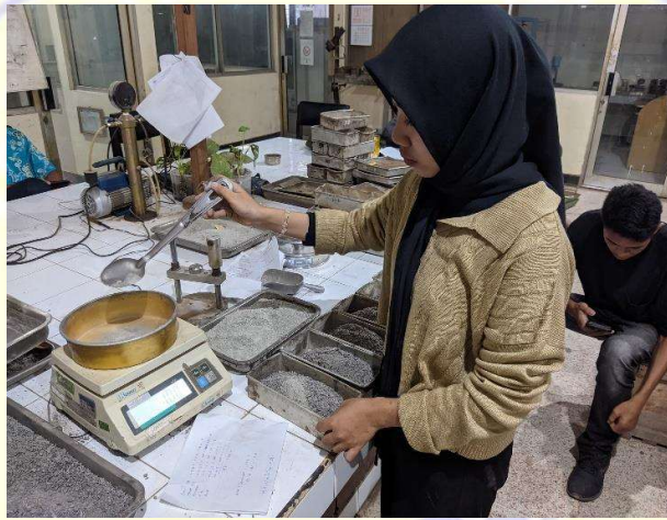
Penimbangan agregat yang sudah di oven dan ditambahkan filler semen
