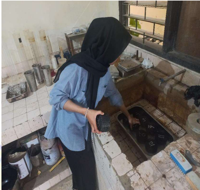
Perendaman benda uji dengan air biasa
