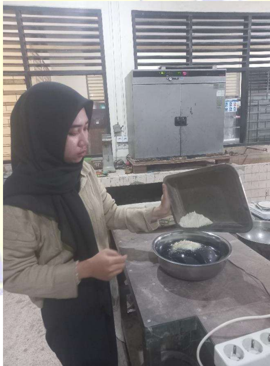
Pencampuran gondorukem dan aspal
