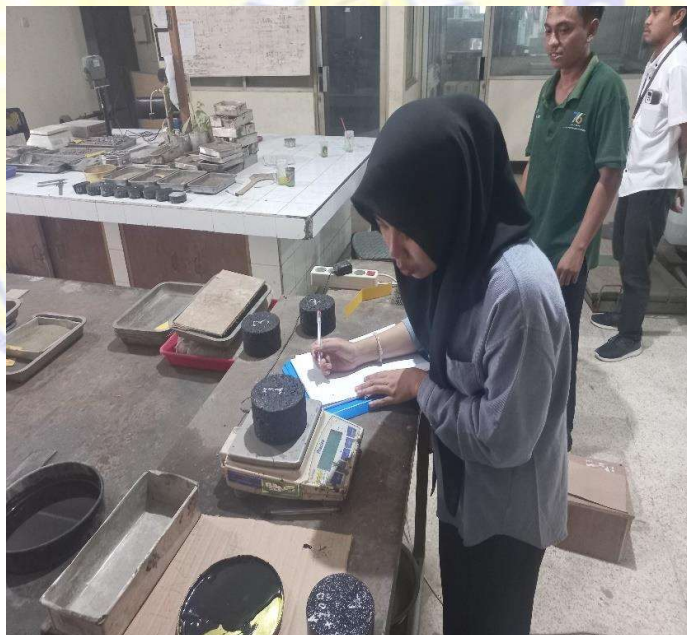
Penimbangan berat benda uji di udara
