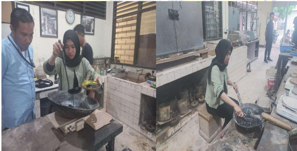
Proses pencampuran agregat dan aspal
