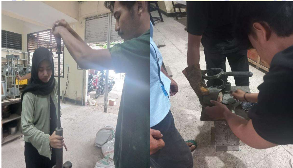
Proses pemadatan dengan penumbukan manual
