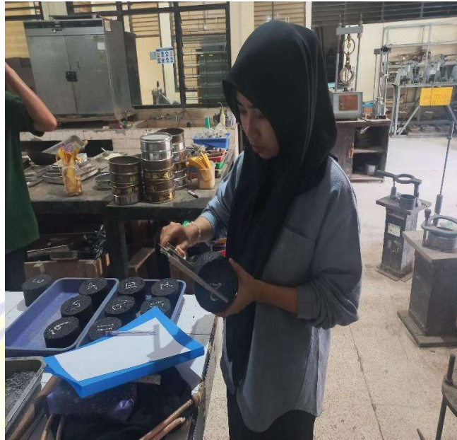
Pengukuran tebal masing – masing benda uji
