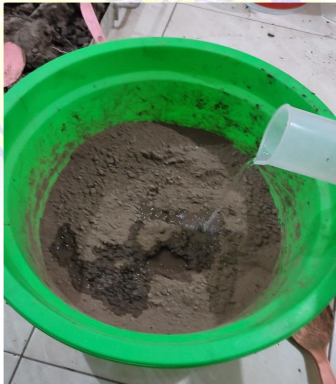
Proses pencampuran air pada campuran tanah dan fly ash
