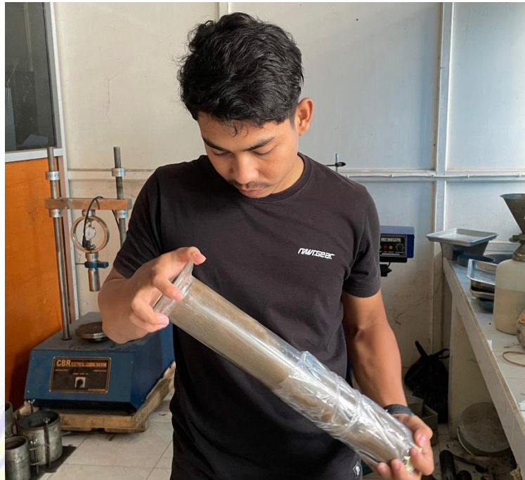
Proses pengadukan bahan uji hydrometer
