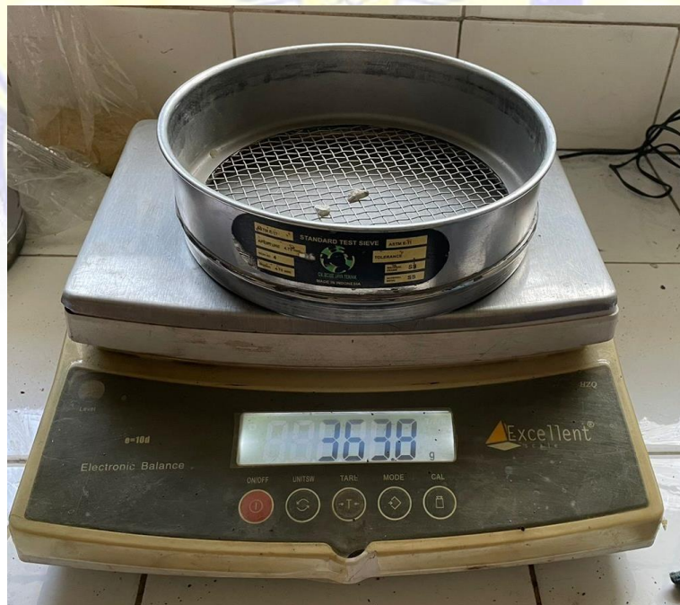
Proses penimbangan hasil saringan tanah dari pengujian hydrometer
