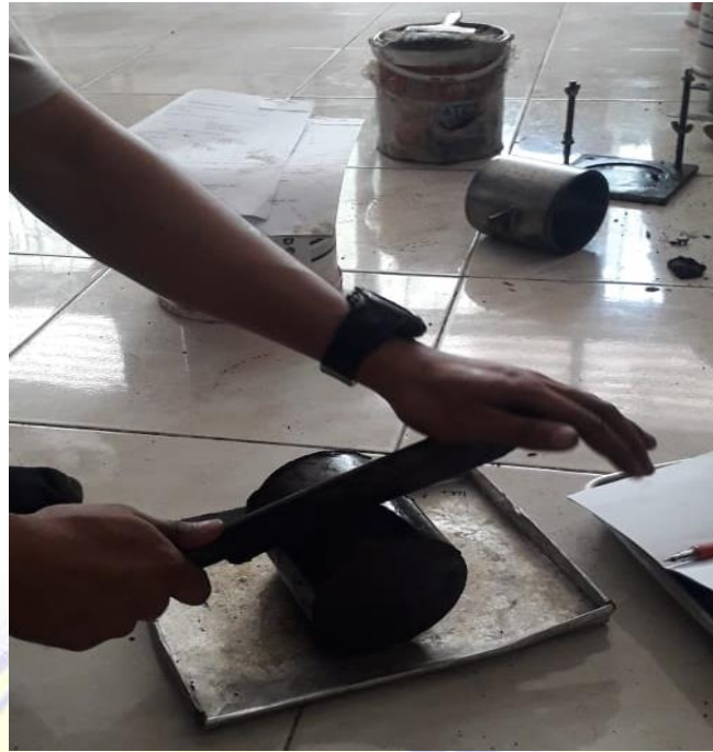
Proses pemotongan tanah menjadi tiga bagian setelah pengujian CBR
