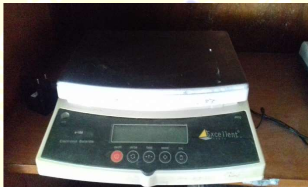
Gambar 3.6 Timbangan ketelitian 0,1 gram
