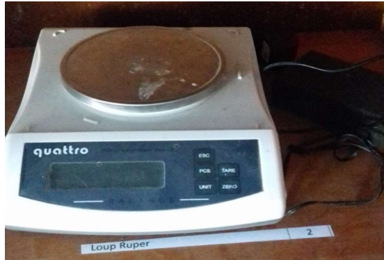
Gambar 3.5 Timbangan ketelitian 0,01 gram
