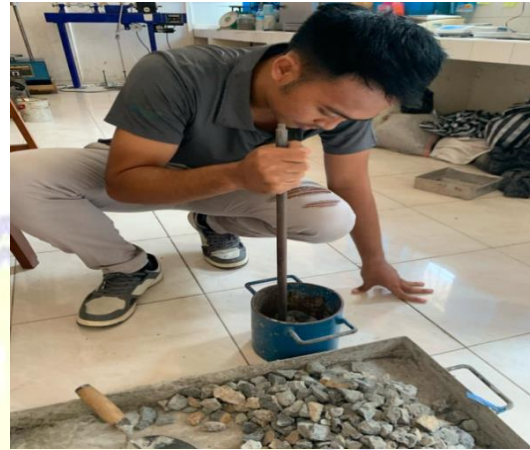
Pengambilan Sampel (Kerikil) Agregat Padat dengan Tumbukan
