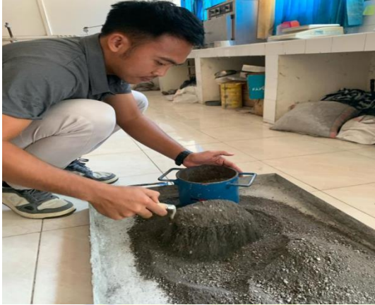
Pengambilan Sampel (Pasir) Agregat Lepas
