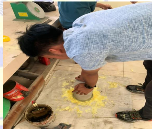
Pemasangan Capping/ Belerang
