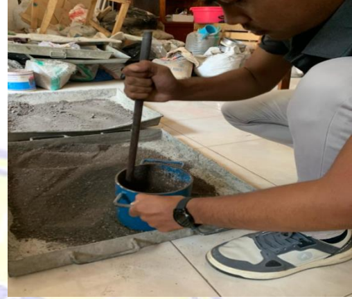
Pengambilan Sample (Pasir) Agregat Padat dengan Tumbukan
