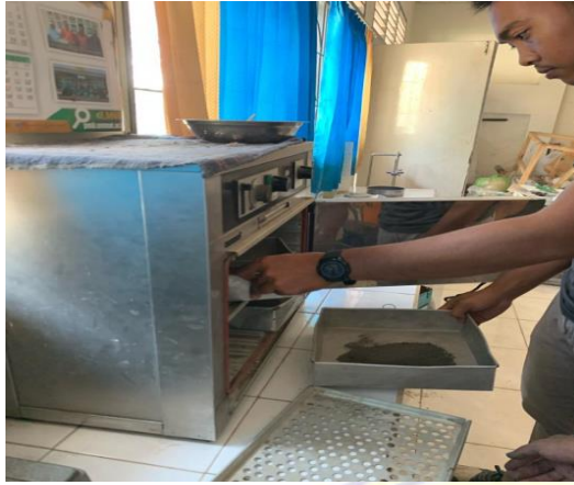
Proses Pengeringan Agregat
