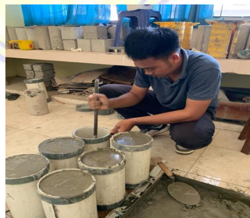
Pencetakan Benda Uji (Silinder Beton)
