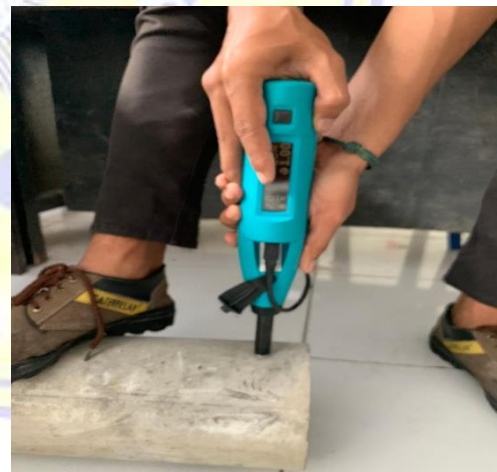
Pengujian Kuat Tekan dengan Alat Hammer Test
