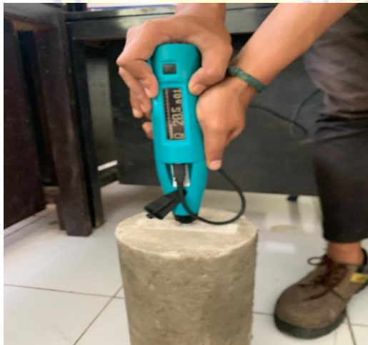
Pengujian Kuat Tekan dengan Alat Hammer Test
