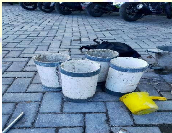
Gambar : 3.11. Cetakan beton
