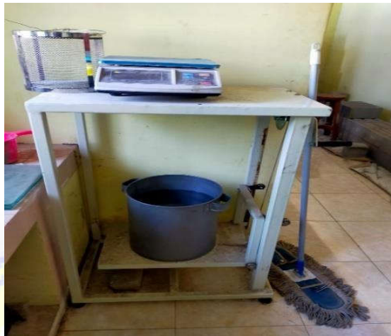
Gambar : 3.12. Keranjang pemeriksa berat jenis Sumber : Dokumentasi Lab Mekanika Tanah, 2023
