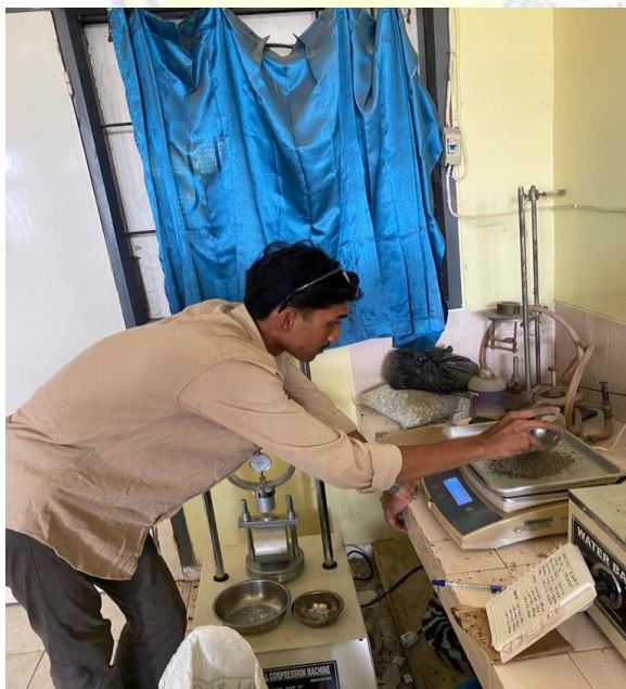
Gambar 2. Penimbangan Berat Agregat
