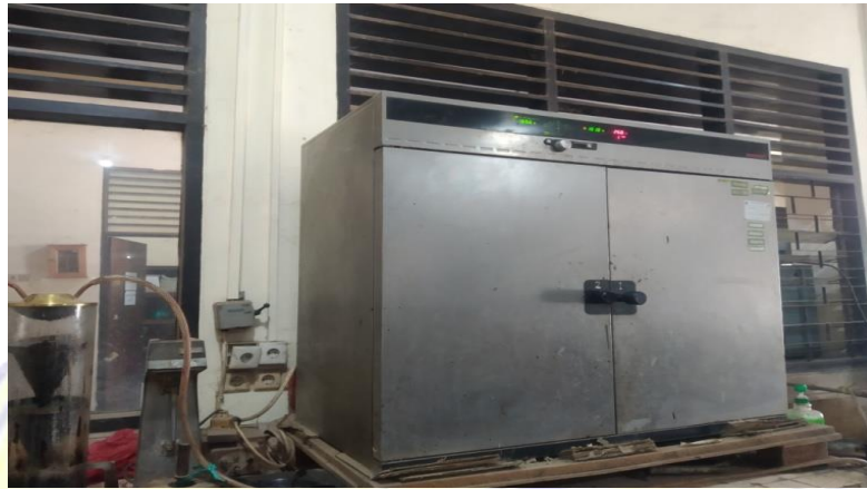
Gambar 3.3 Oven atau Pemanas Agregat
