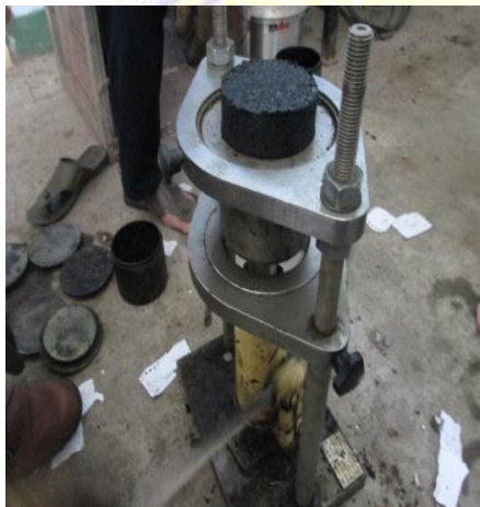
Pengeluaran Briket Dari Cetakan Mold
