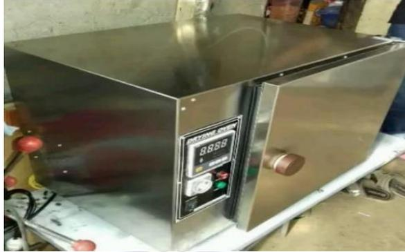
Gambar 3. 4 Oven atau pemanas agregat
