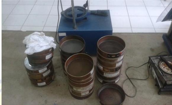
Gambar 3. 2 Satu Set Alat Uji Saringan AS
