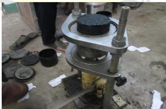
Gambar 3. 9 Dongkrak Hidraulis
