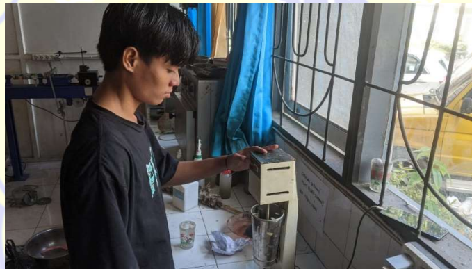
Gambar. Mixer tanah sebelum pengujian hidrometer
