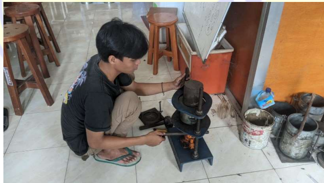
Gambar. Pengeluaran benda uji menggunakan ekstruder hidrolik
