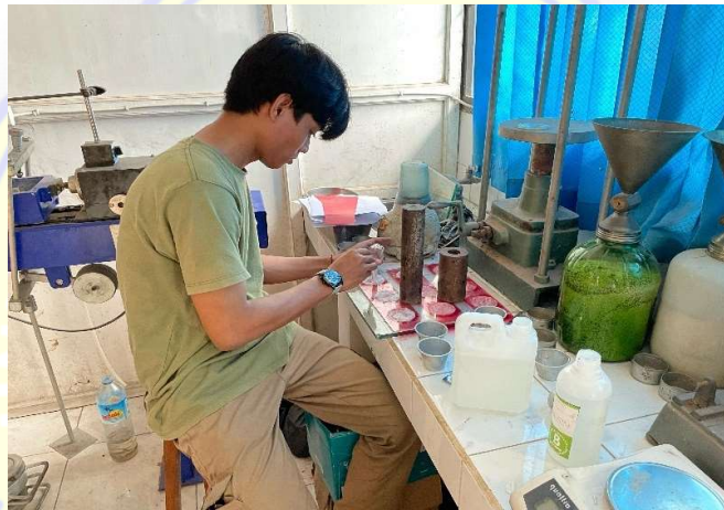
Gambar. Proses pembuatan komposit resin epoxy
