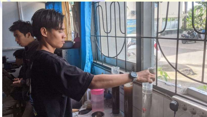
Gambar. Analisa saringan hidrometer
