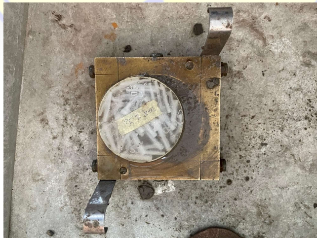
Gambar. Hasil uji kuat geser interface menggunakan komposit resin epoxy
