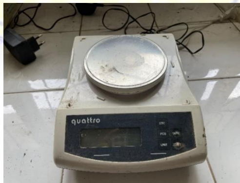
Gambar 3. 4 Timbangan dengan akurasi 0,01 gr
