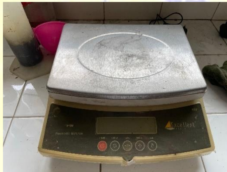
Gambar 3. 3 Timbangan dengan akurasi 0,1 gr
