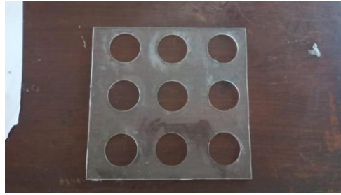
Gambar 3. 11 Cetakan komposit resin epoxy
