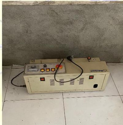
Mesin Sealer merupakan mesin yang digunakan untuk membantu dalam proses pengemasan suatu produk yang memiliki bungkus dari bahan plastik.
