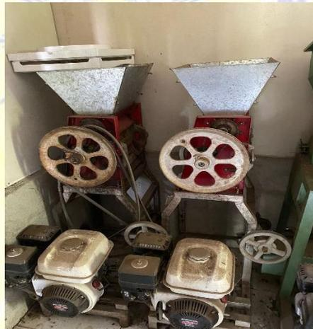
Mesin penggiling adalah mesin yang digunakan untuk menggiling biji kopi yang telah disangrai menjadi berbentuk bubuk.
