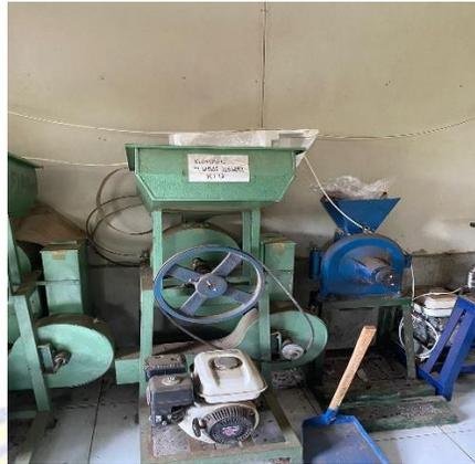
Mesin Huller Kopi adalah mesin yang digunakan untuk mengupas kopi yang sudah dikeringkan sekaligus memisahkan antara biji kopi bersih dengan kulit tanduknya.
