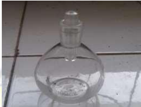
Gambar 3. 16 Alat Picnometer (Sumber: Dokumentasi, 2023)
