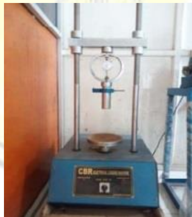
Gambar 3. 23 Mesin Penetrasi CBR (Sumber: Dokumentasi, 2023)
