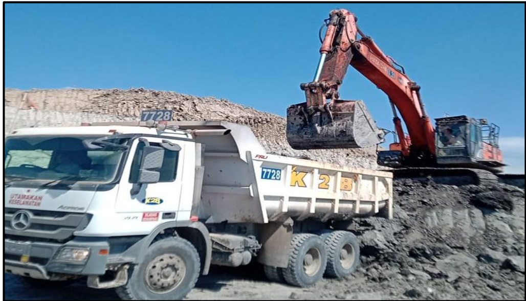
Gambar 2. 10 Pengupasan Overburden (Sumber: Dokumentasi Pribadi, 2023)
