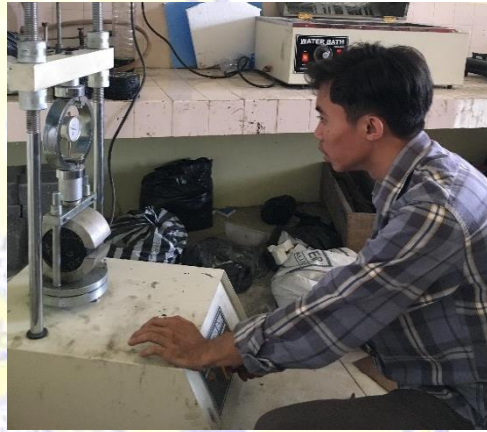
Proses penimbangan berat di dalam air dan pengujian marshall
