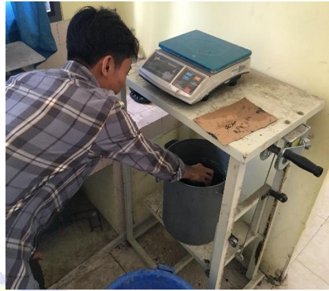
Proses penimbangan berat udara benda uji dan perendaman di dalam air
