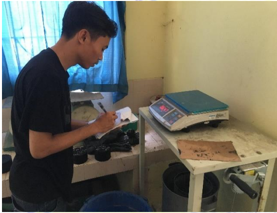
Proses penimbangan berat di dalam air dan pengujian marshall
