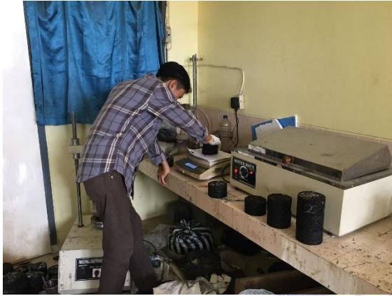
Proses penimbangan berat udara benda uji dan perendaman di dalam air
