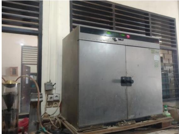
Gambar 3. 3 Oven atau Pemanas Agregat
