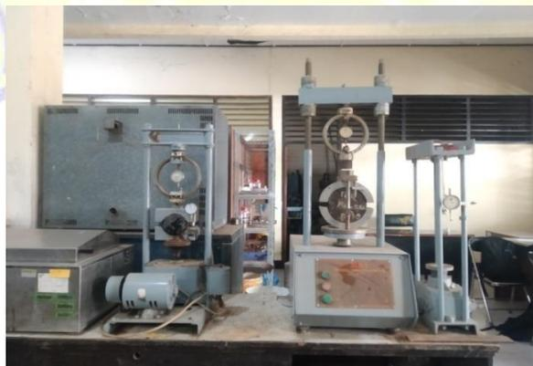
Gambar 3. 10 Satu Set Uji Alat Marshall
