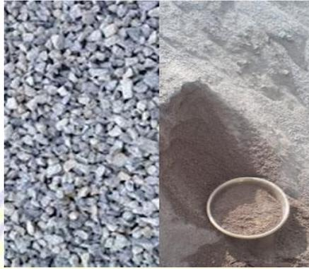
Gambar 3. 14 Agregat kasar dan agregat halus
