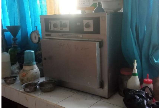
Gambar 3. 5 Oven atau pemanas agregat (Sumber : Dokumentasi Pribadi, 2024)
