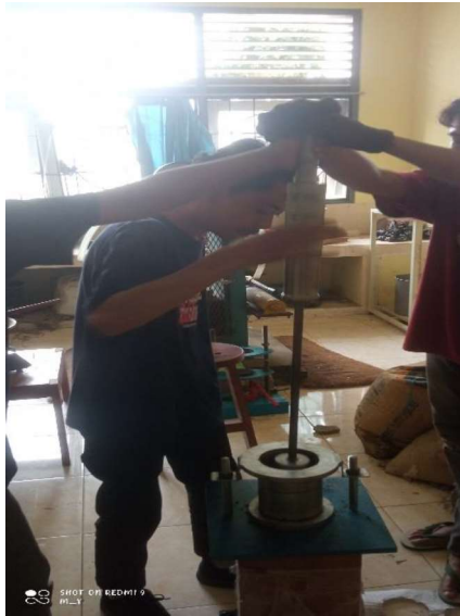
Penumbukan pada benda uji
