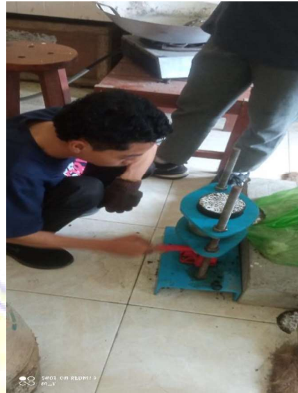
Pengeluaran benda uji dari mold
