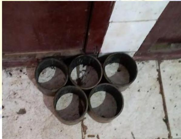
Gambar 3. 7 Cetakan Benda Uji Briket
