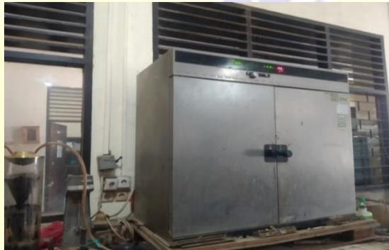
Gambar 3. 4 Oven atau Pemanas Agregat
