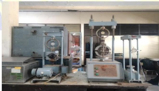
Gambar 3. 11 Satu Set Uji *Alat Marshall*
