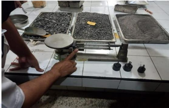
Gambar 3. 15 Agregat kasar dan agregat halus
