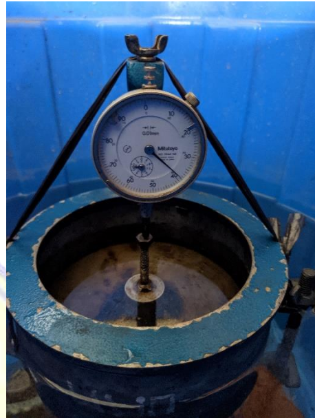
Pembacaan dial guage tanah asli 1 jam Pembacaan dial guage tanah asli 2 jam
