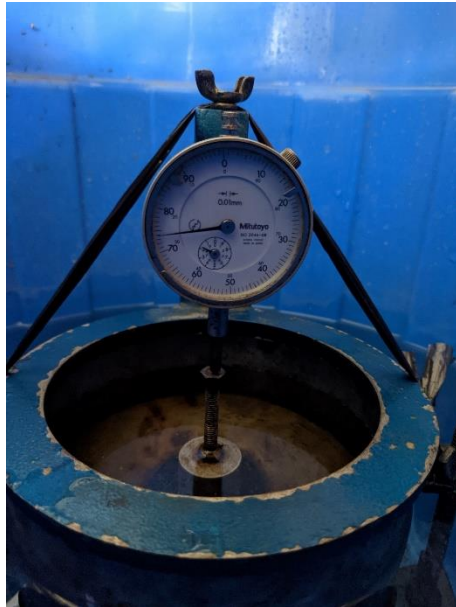
Pembacaan dial guage tanah asli 1 jam Pembacaan dial guage tanah asli 2 jam
