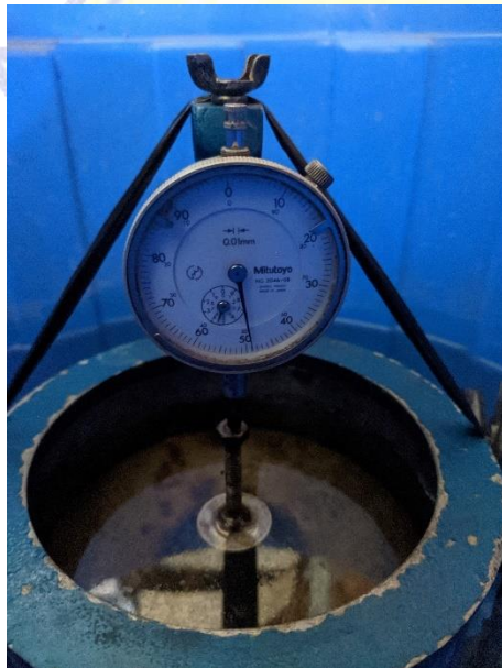
Pembacaan dial guage tanah asli 4 jam Pembacaan dial guage tanah asli 8 jam
