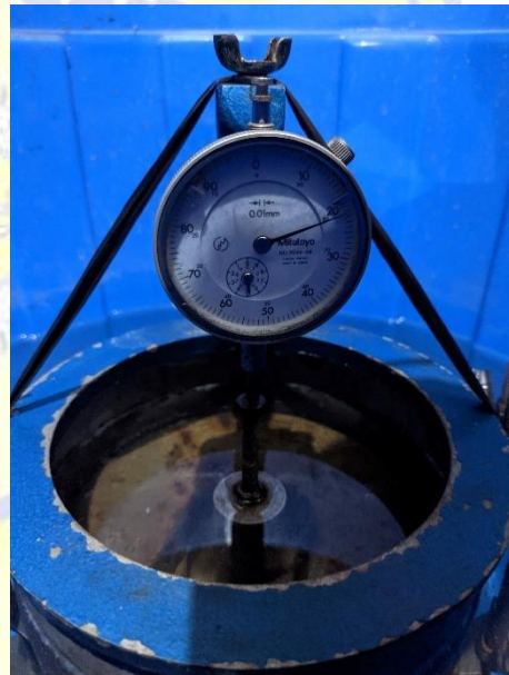
Pembacaan dial guage tanah asli 4 jam Pembacaan dial guage tanah asli 8 jam
