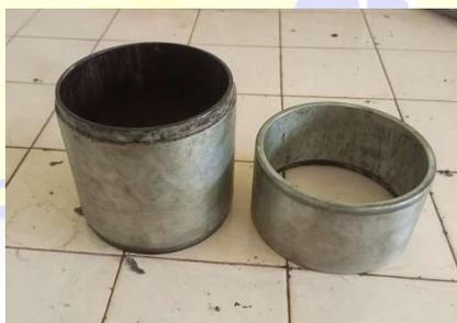
**Gambar 3.5** Cetakan Benda Uji
