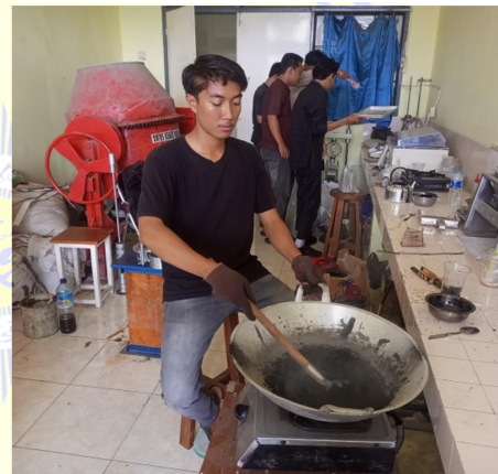
Proses pencampuran agregat dengan aspal
