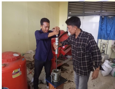
Proses pemadatan campuran
