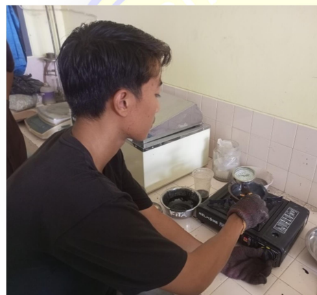
Pengukuran suhu aspal
