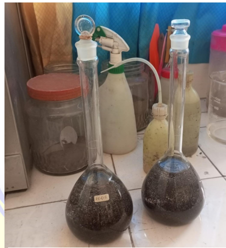
Pengujian berat jenis dan penyerapan agregat
