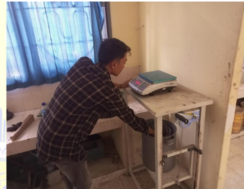
Proses penimbangan di dalam air
