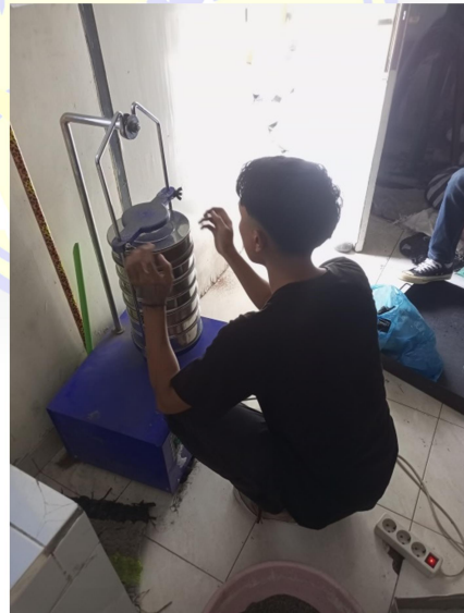
Proses pengayakan menggunakan mesin ayakan
