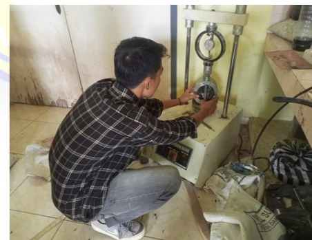
Proses pengujian stabilitas dan flow dengan alat marshall
