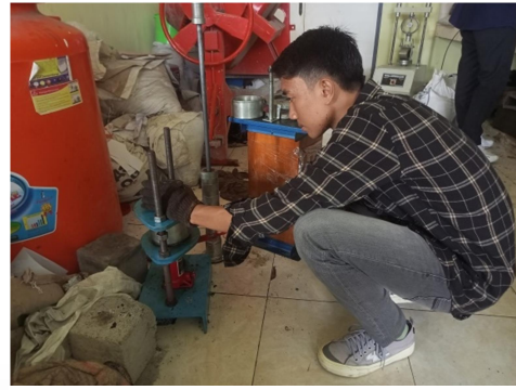
Proses pengeluaran sampel dari Mould menggunakan dongkrak hidrolik
