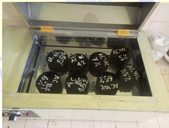
Perendaman sampel di dalam waterbath selama 30 menit dengan suhu 60°C
