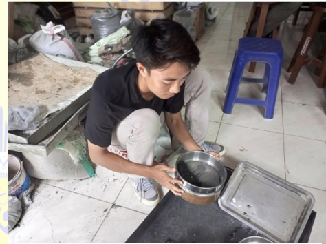
Proses pengayakan secara manual
