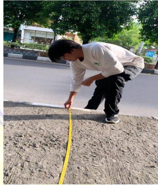
(Gambar D.2: Mengukur lebar trotoar)
