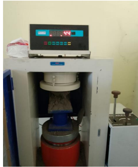
Benda uji 2 Fly Ash 50%
