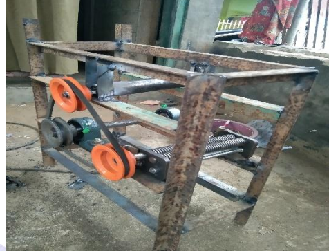
Pemasangan Rol Pemipih dan Pisau Pencetak
