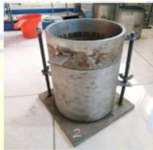
Gambar 3. 15 Cetakan atau Mold
