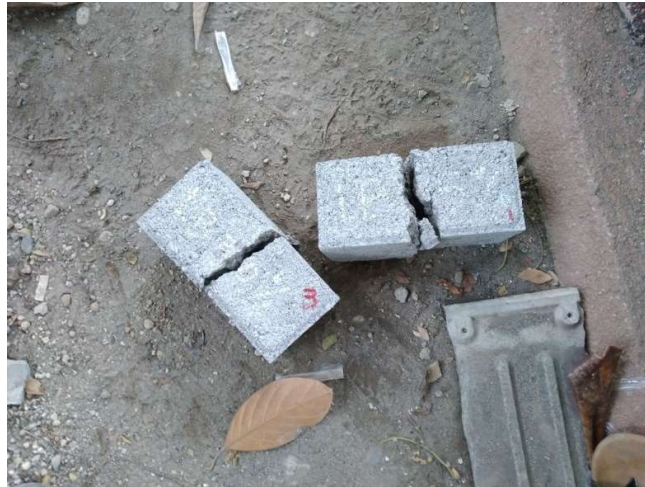
Gambar 13. (a) Alat Proctor Test Untuk Menguji Ketahanan Impact Pada Sampel (b) Proses Pengujian Impact (c) Kondisi Sampel Setelah Proses Pengujian Impact
