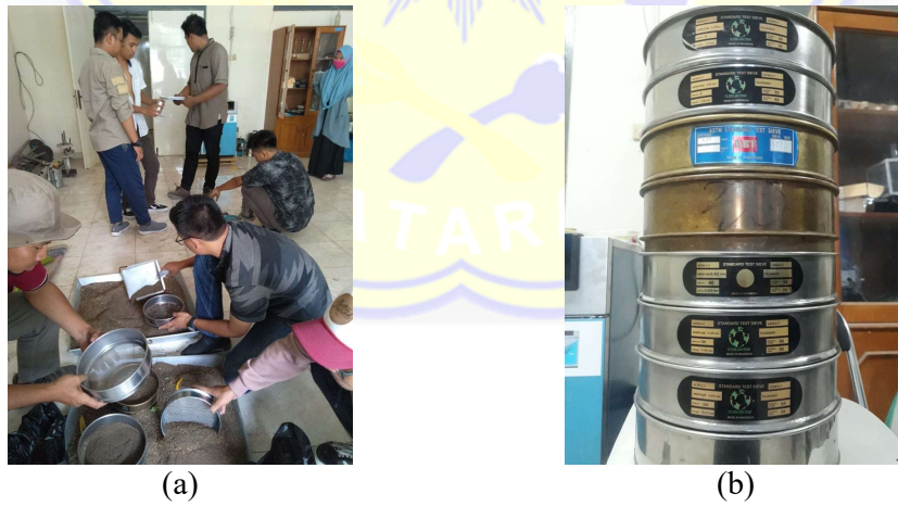
Gambar 3. (a) Proses Penyaringan Agregat dengan Menggunakan Saringan (b) Alat Uji Saringan
