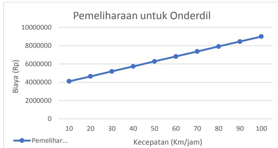
Gambar 4. 4 Hubungan Biaya Pemeliharaan dan Kecepatan
