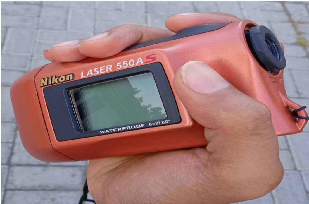
Alat yang digunakan untuk mengukur panjang saluran drainase
